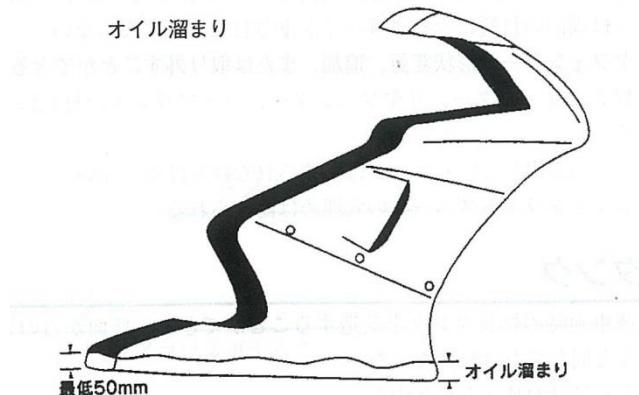
7-3-10-6-2 フェアリング下部には、直径 20 mm(許容誤差 +5mm)の水抜き用の孔を最低1個設けなければならぬ(孔は2個までとする)。
