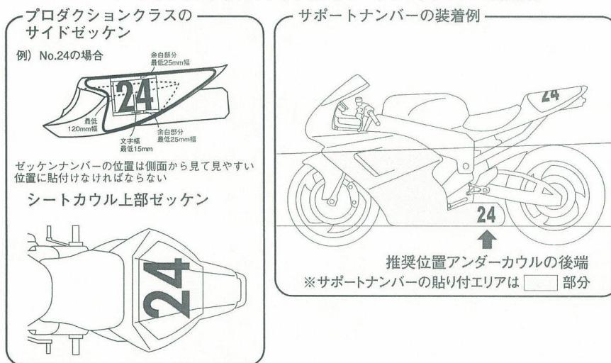
⑨ アンダーカウルの左右両面にサポートナンバーを付けなければならない。
